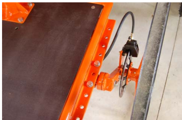
L'essieu s'avance ou se recule par rapport à l'axe de la caisse, afin d'obtenir un bon équilibrage du sulky
