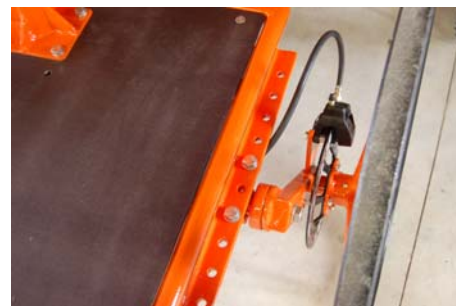
Réglage de la potence du siège en hauteur ainsi que d'avant en arrière sur le plancher, Le siège meneur se règle également d'avant en arrière
