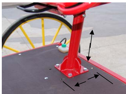
Réglage de la potence du siège en hauteur ainsi que d'avant en arrière sur le plancher, Le siège meneur se règle également d'avant en arrière
