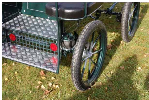
Suspensions arrière à air gonflable et barres stabilisatrices
