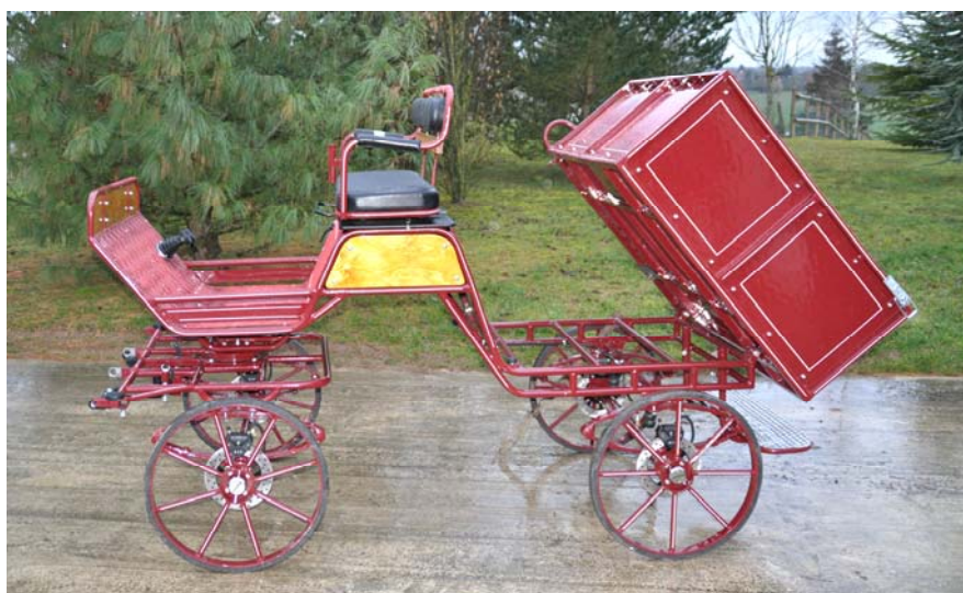
Largeur de voie 120 cm , longueur totale 2.35 m Benne basculante largeur 1.20 m longueur 1 m, hauteur ridelles 0.45 cm
