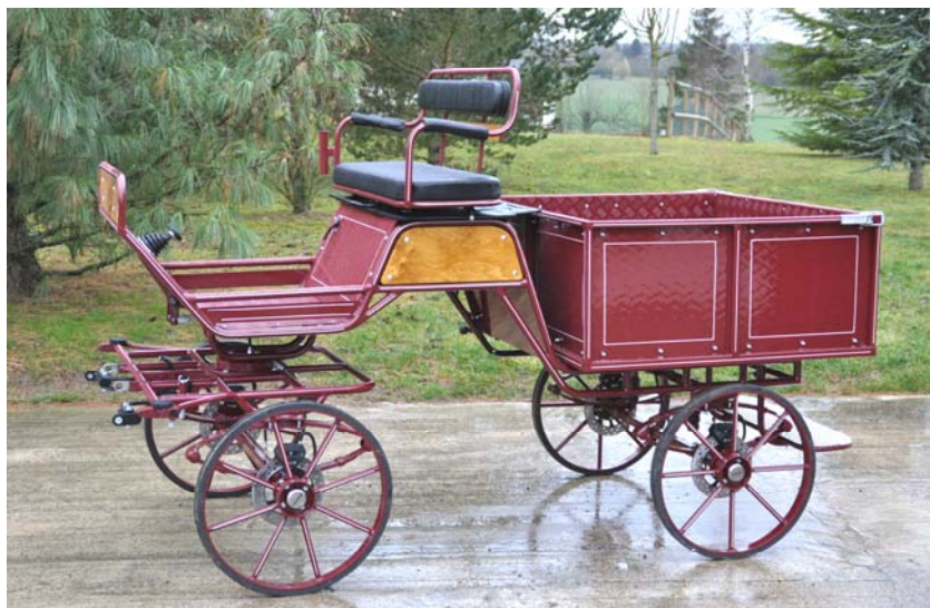
Largeur de voie 120 cm , longueur totale 2.35 m Benne basculante largeur 1.20 m longueur 1 m, hauteur ridelles 0.45 cm
