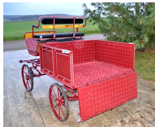
Largeur de voie 120 cm , longueur totale 2.35 m Benne basculante largeur 1.20 m longueur 1 m, hauteur ridelles 0.45 cm
